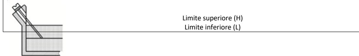
Ogni volta che si avvia il generatore, è necessario controllare il livello dell'olio. Se non è sufficiente, è necessario rabboccare l'olio lubrificante fino al livello prescritto. Lo scarico dell'olio lubrificante può essere effettuato immediatamente dopo lo spegnimento del motore, poiché quando il motore è freddo è difficile scaricare completamente l'olio.
