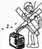
No fumar mientras se repontan combustibles
